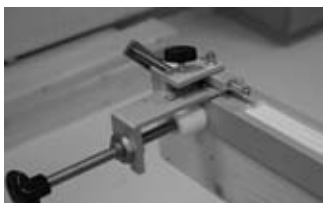
Afb. 1 Aanslagnok tegen onderzijde deur
