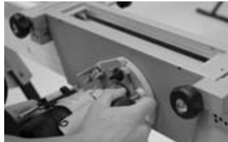
Afb. 15 Uitfrezen krukgat en cilindergat.
